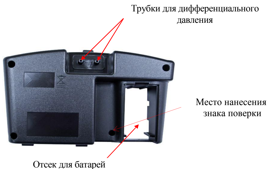
Рисунок 2 - Общий вид микроанометров 8380 (сзади) и схема пломбировки с нанесением знака поверки
