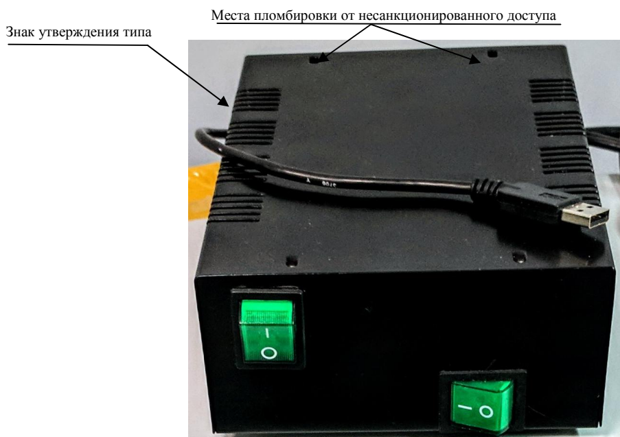
Рисунок 2 – Схема пломбировки от несанкционированного доступа и место размещения знака утверждения типа
