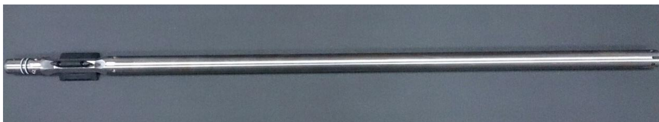
Рисунок 1 – Общий вид забойной части модулей инклинометрии и гамма-каротажа Aquarius
