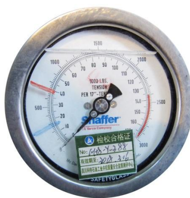
Рисунок 2 – Фотография общего вида манометра ENP-GF № NH8-Y-388
