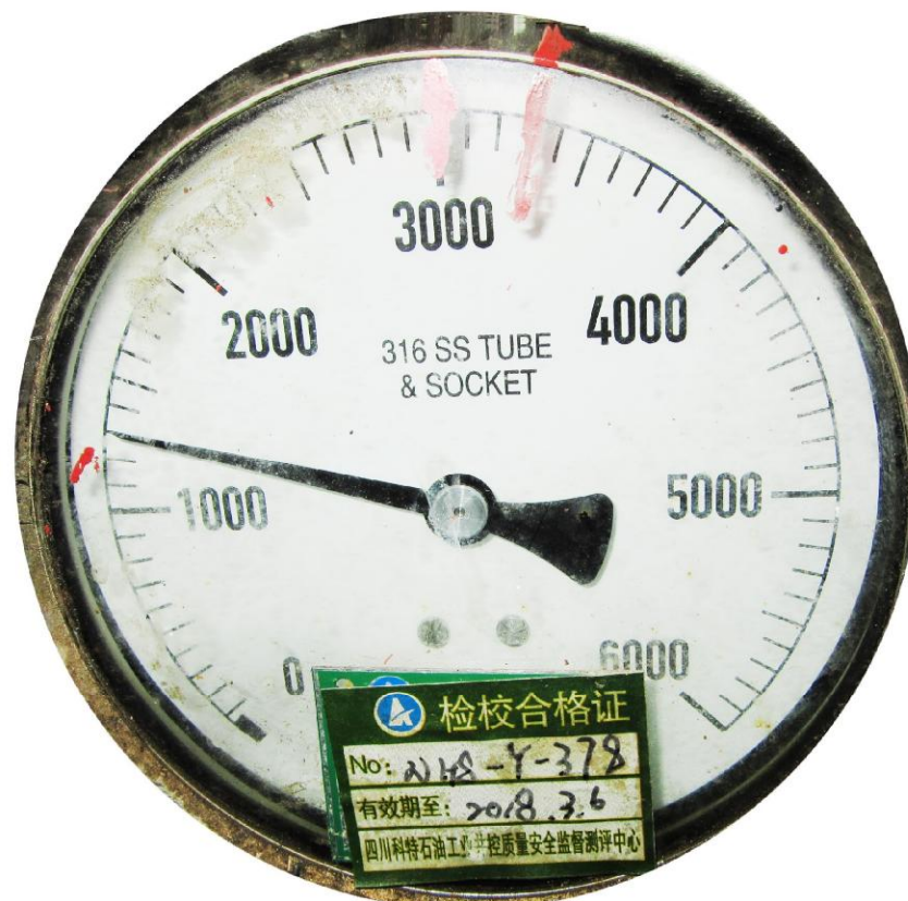
Рисунок 1 – Внешний вид манометра деформационного показывающего 40-400-6000
