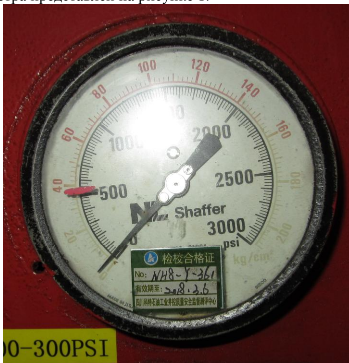
Рисунок 1 – Внешний вид манометра деформационного показывающего 100FIA44A21C
