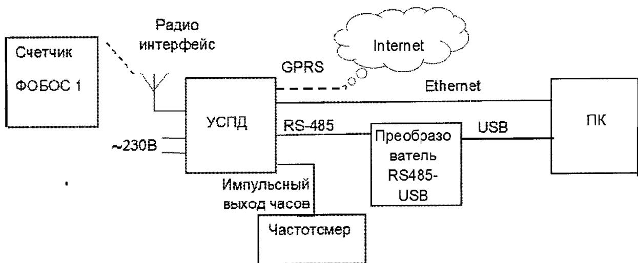
Рисунок 1 - Схема для опробования и поверки УСПД.
