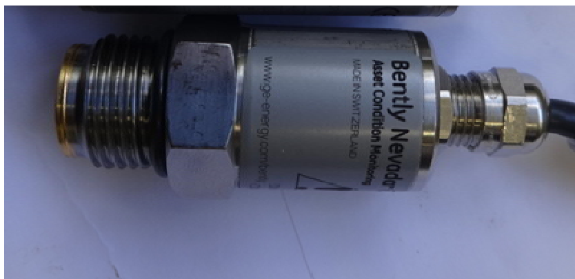
Рисунок 1 - Внешний вид преобразователя переменного давления 165855
