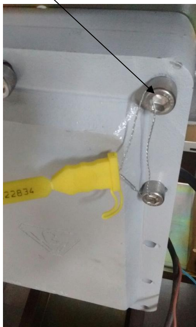
Рисунок 2 - Схема пломбировки от несанкционированного доступа, обозначение мест нанесения знака поверки и пломбы завода-изготовителя
