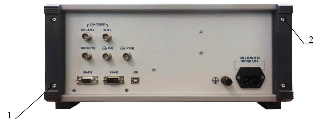
1, 2 - места пломбировки от несанкционированного доступа
