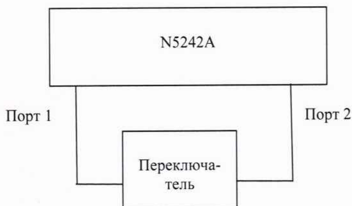
Рисунок 1 – Схема подключения при определении начального ослабления и КСВН входа переключателя
