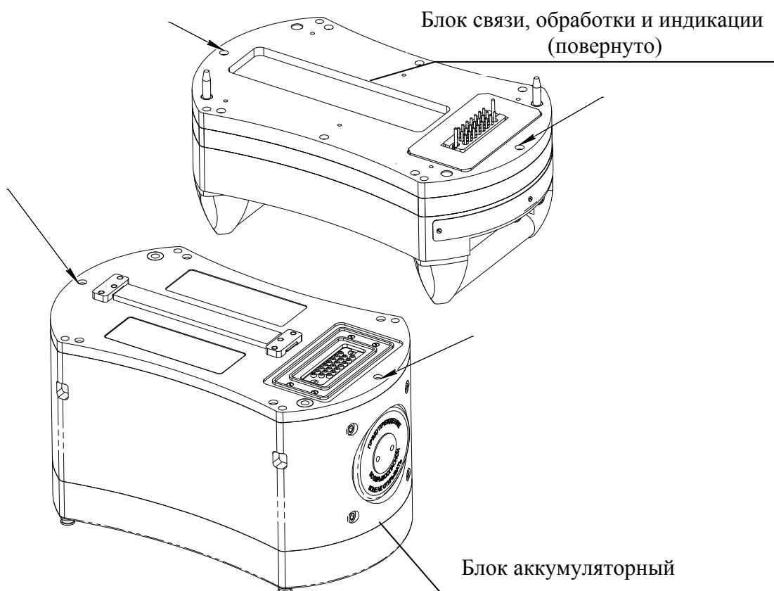
Рисунок 2 - Схема пломбировки газоанализаторов от несанкционированного доступа (стрелками указаны места нанесения пломб)
