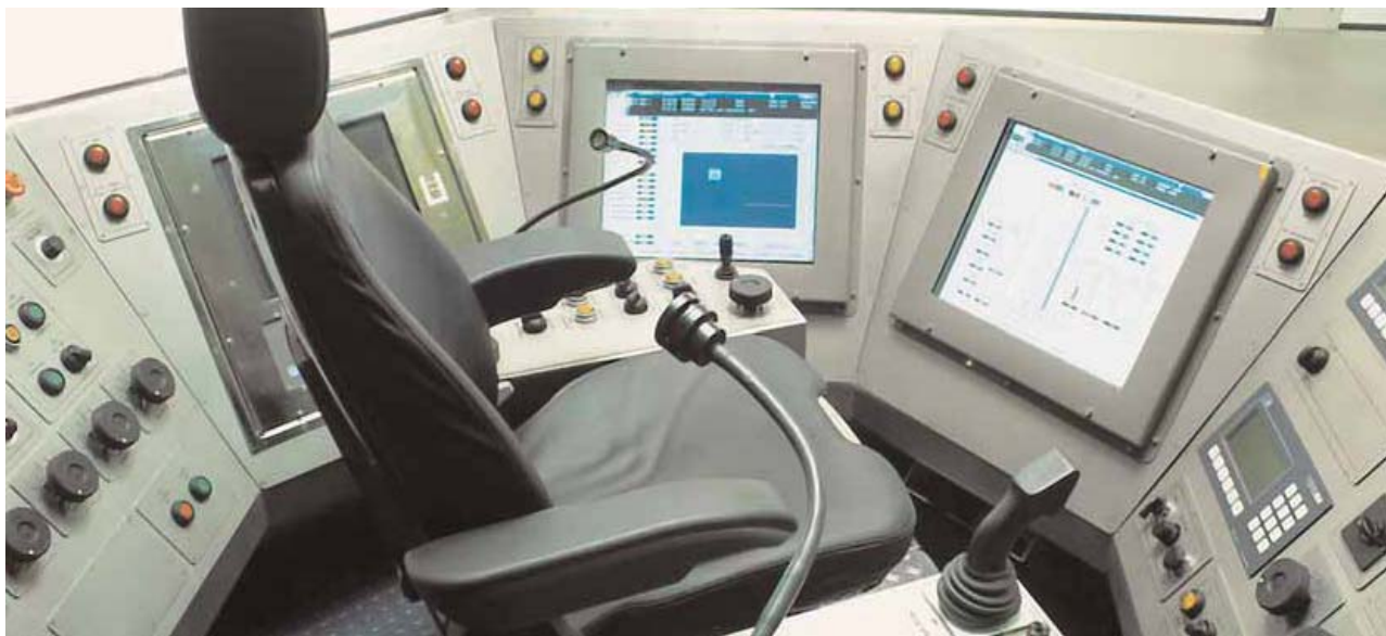
Рисунок 1 - Общий вид пульта бурильщика системы контроля параметров бурения (СКПБ) infoDRILL
