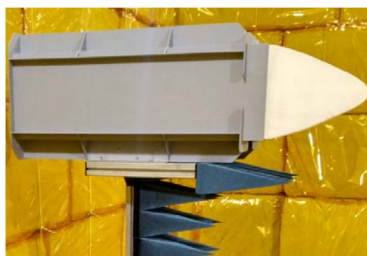
Рисунок 5 - Внешний вид антенны-зонда ТМА3 8-20 И диапазона частот 8 - 20 ГГц (слева), внешний вид антенны ТМА 2.5-20 Э (справа)
