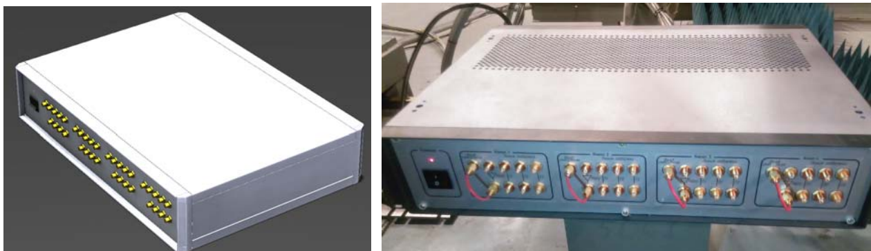
Рисунок 5 - Конструкция и внешний вид четырехканального стробоскопического приемного модуля
