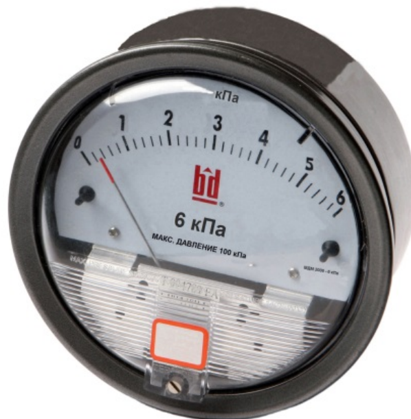
Рисунок 2 - Общий вид манометров, отградуированных в кПа
