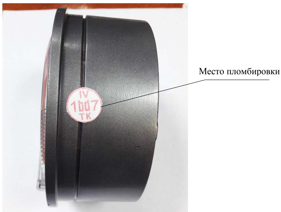
Рисунок 3 - Схема пломбировки манометров
