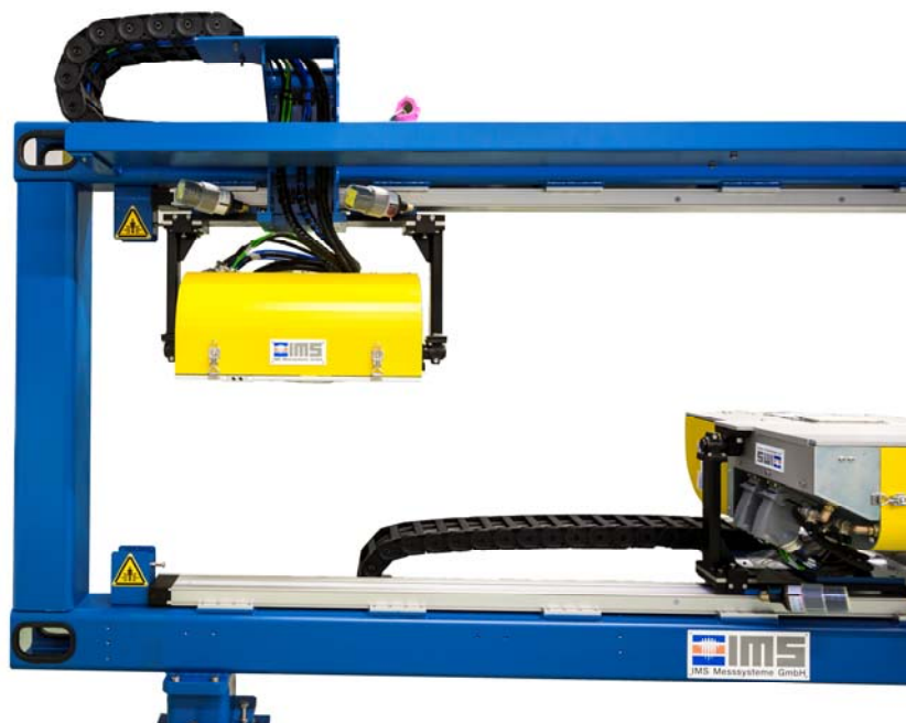
Рисунок 1 - Общий вид систем измерений толщины покрытий листового проката рентгеновских серии CWG-R
