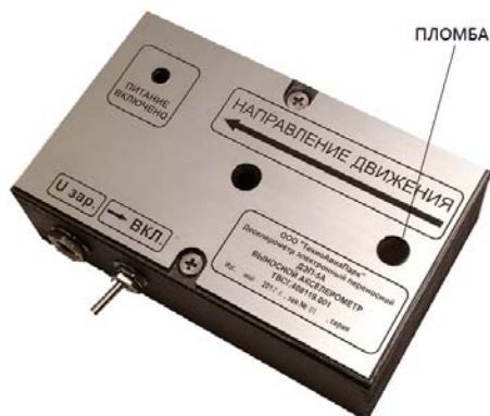
Рисунок 2 - Схема пломбировки выносного акселерометра от несанкционированного доступа
