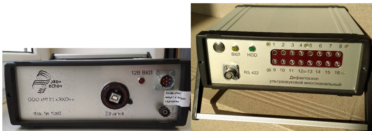
Рисунок 2 - Общий вид блока системного ДУМ.СК26
