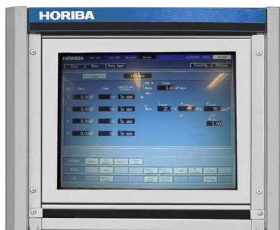
Рисунок 2 - Система отбора постоянных объемов пробы CVS-7000 (блок управления MCU)
