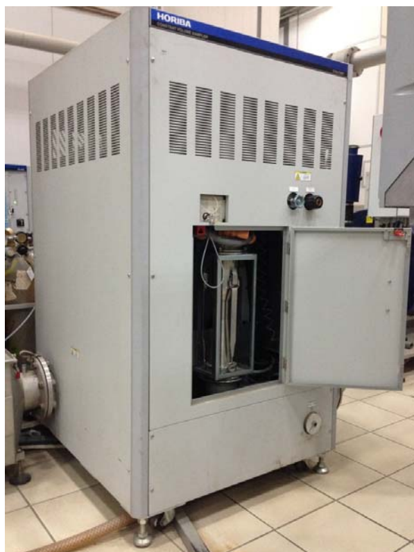
Рисунок 1 - Система отбора постоянных объемов пробы CVS-7000 (блок отбора выхлопных газов ESU)
