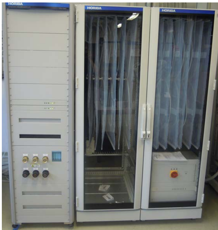
Рисунок 3 - Система отбора постоянных объемов пробы CVS-7000 (блок отбора проб в мешки BSU и подогреваемый шкаф для пробоотборных мешков)
