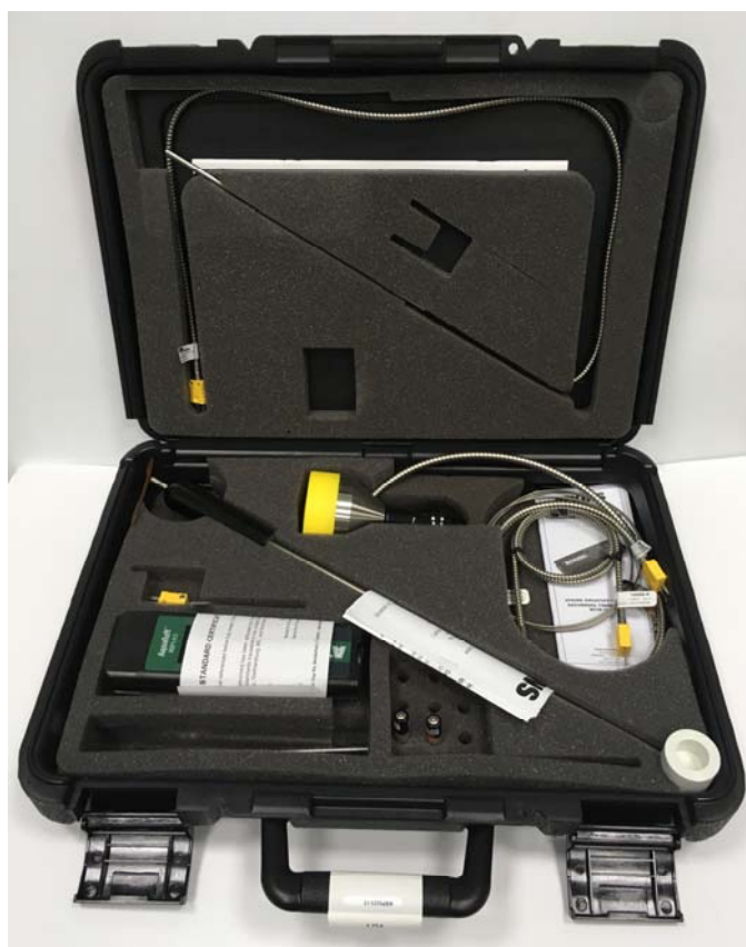
Рисунок 2 - Общий вид поставляемого комплекта: переносной чемодан для транспортировки термометра с измерительными зондами
