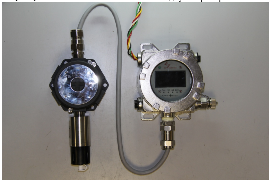
б) Газоанализатор Vector с выносным преобразователем газовым
