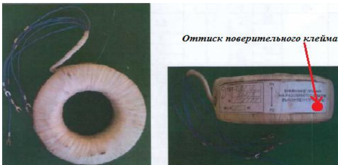
Рисунок 1 - Внешний вид трансформаторов
