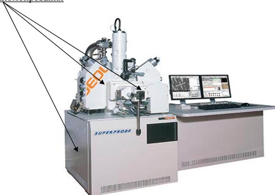
Рисунок 2 - Схема пломбировки от несанкционированного доступа
