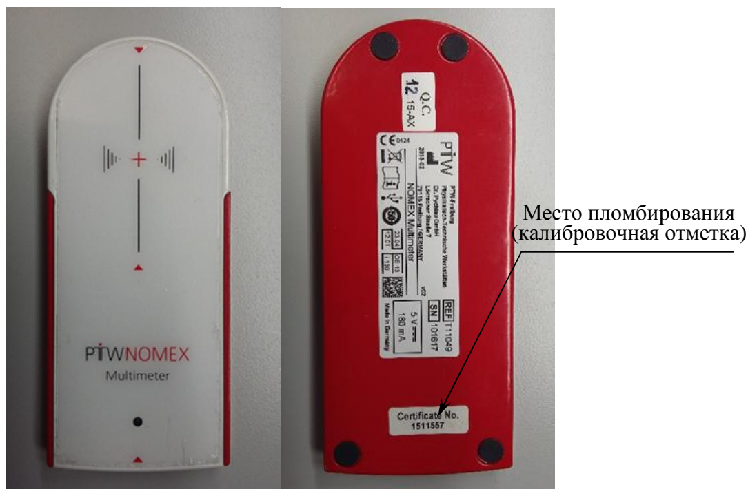
Рисунок 1 - Общий вид дозиметров универсальных для контроля характеристик рентгеновских аппаратов NOMEX Multimeter с указанием места пломбирования
