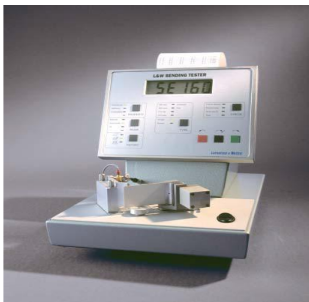
Рисунок 1 - Общий вид приборов для определения сопротивления изгибу SE 160
