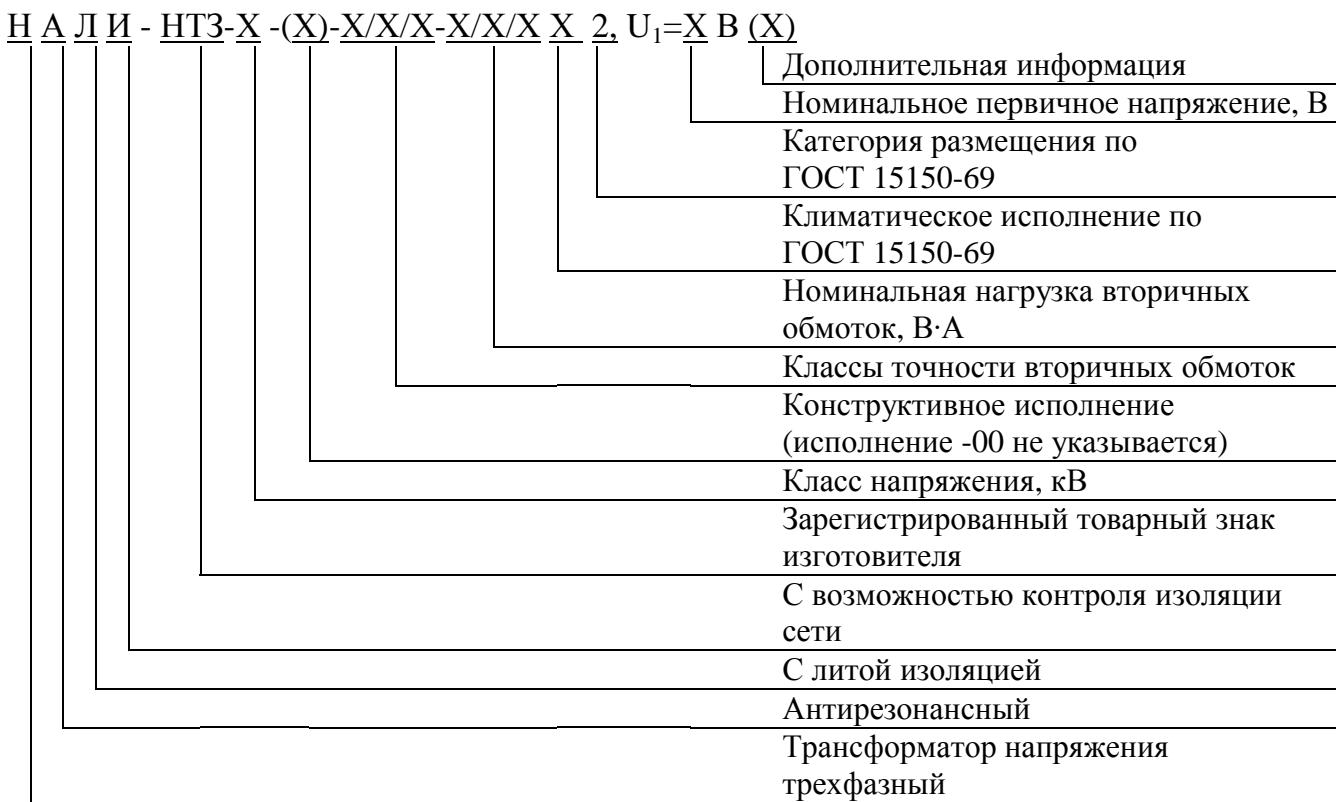
Рисунок 4 – Структура условного обозначения трансформаторов напряжения НАЛИ-НТЗ
