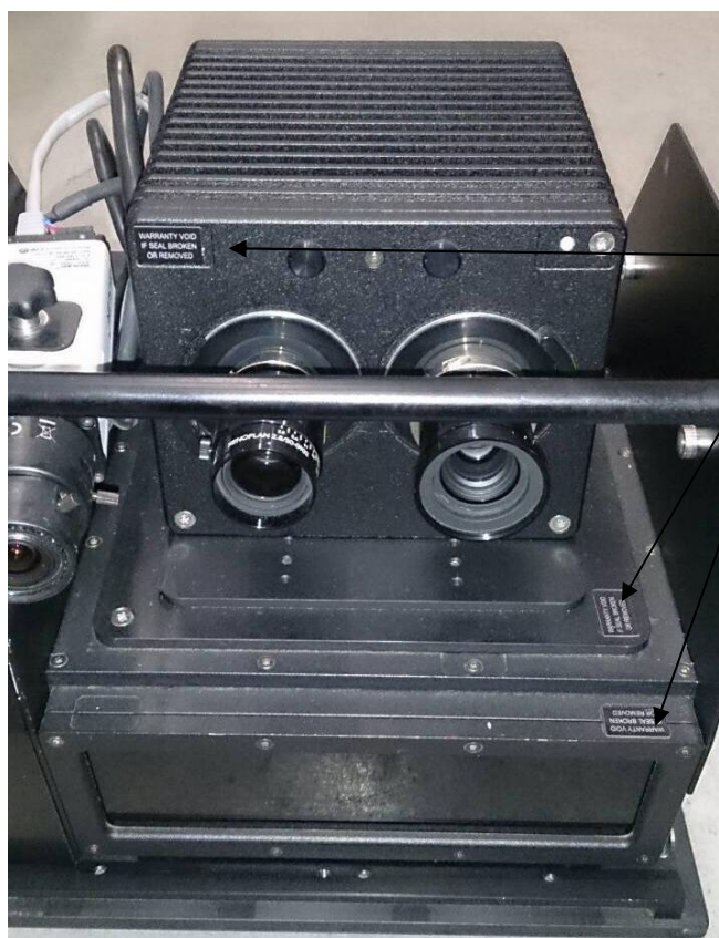
Рисунок 5 - Внешний вид измерительного блока ИС с указанием мест пломбирования
