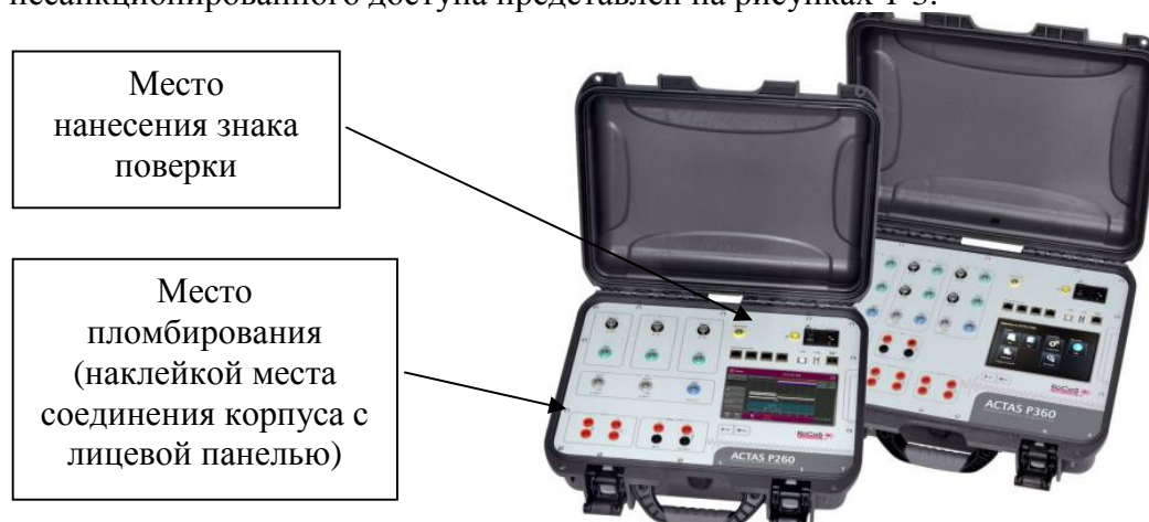
Рисунок 1 - Внешний вид АСТАС Р260, АСТАС Р360 с указанием мест нанесения знака поверки и пломбирования от несанкционированного доступа
