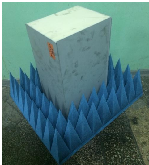
Рисунок 3 - Внешний вид вспомогательных антенн ТМА 1-6 И диапазона частот 1-6 ГГц и ТМА 6-18 И диапазона частот 6-18 ГГц
