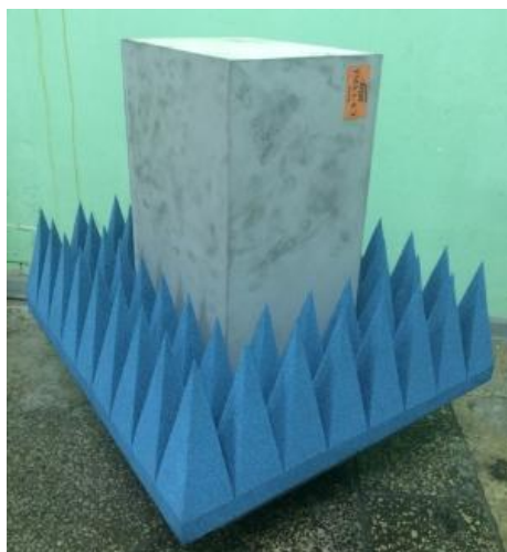
Рисунок 4 - Внешний вид эталонных антенн ТМА1-6 Э диапазона частот 1-6 ГГц, ТМА 6-18 Э диапазона частот 6-18 ГГц
