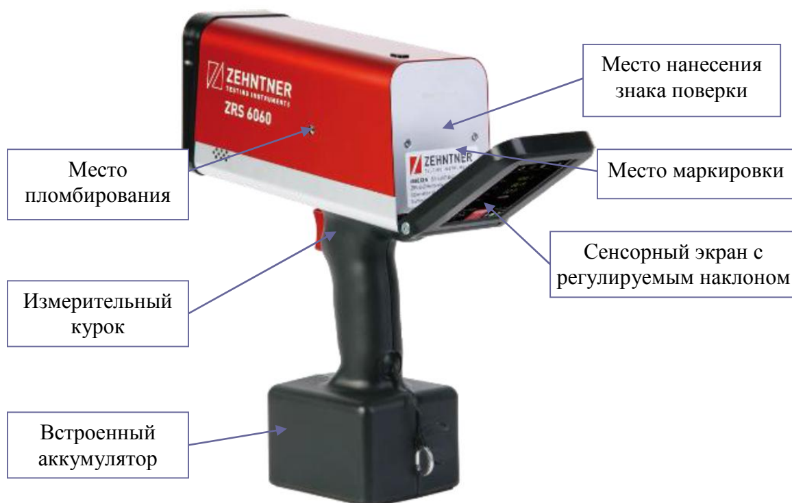
Рисунок 2 - Общий вид ретрорефлектометров ZRS 6060 с указанием мест нанесения маркировки, знака поверки и пломбирования
