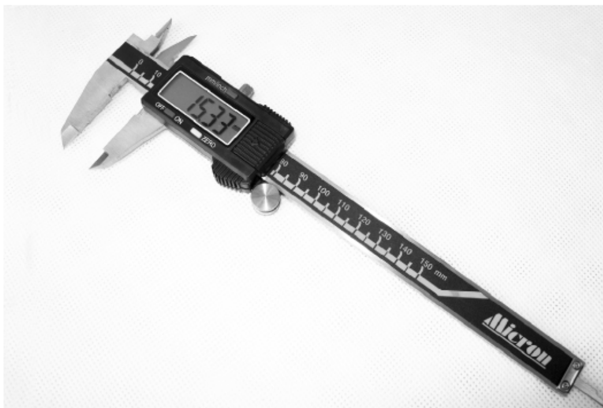
Рисунок 5 - Общий вид штангенциркулей с цифровым отсчетным устройством двусторонних с глубиномером
