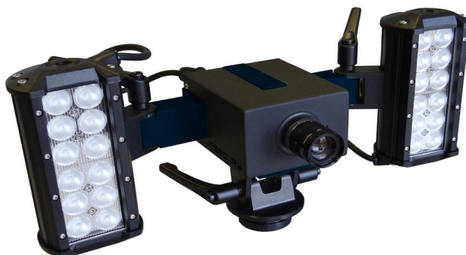
Рисунок 1 - Внешний вид измерителей перемещений (деформаций) оптических бесконтактных серии VEX
