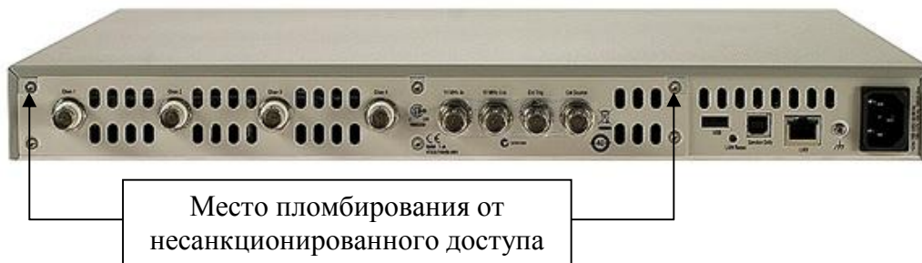
Рисунок 3 - Схема пломбировки от несанкционированного доступа
