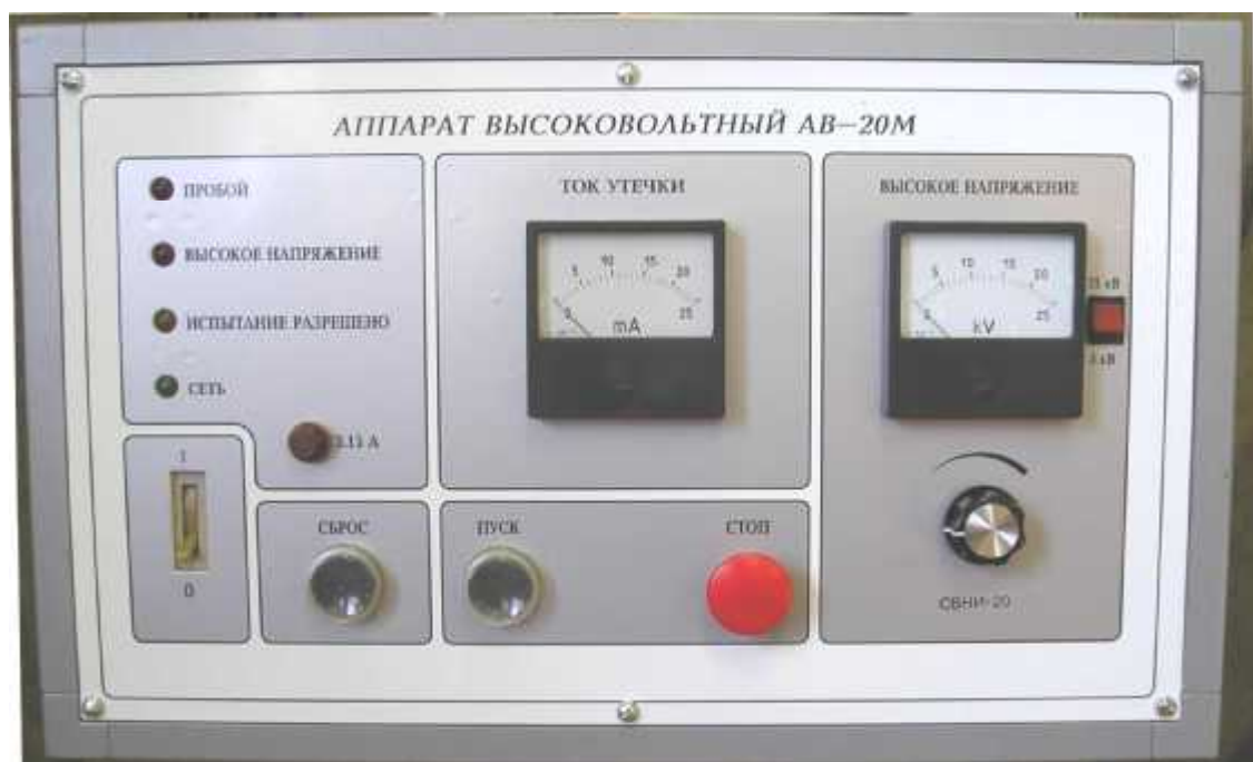
Рисунок 1 - Общий вид систем СВНИ-20 в составе аппарата высоковольтного АВ-20М
