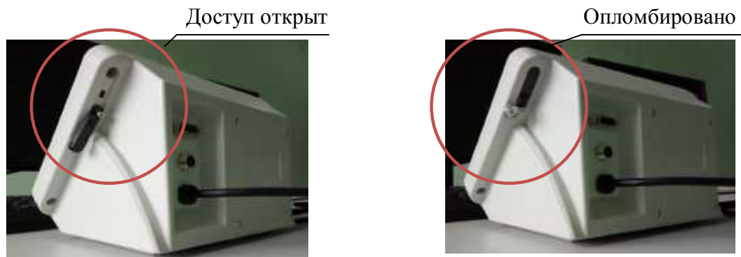
Рисунок 2 - Схема пломбировки от несанкционированного доступа
