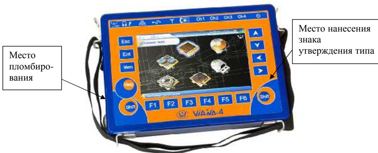
Рисунок 1 - Общий вид измерительного блока
