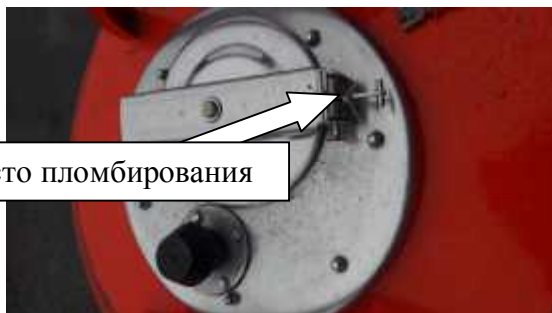
Рисунок 3 - Запорный механизм крышки заливной горловины АТЗ
