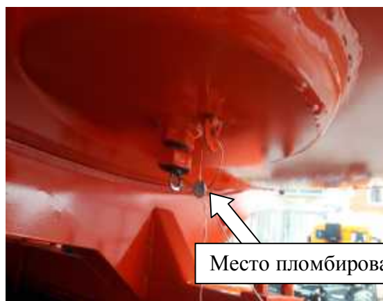
Рисунок 6 - Кран сливной для слива отстоя из АТЗ
