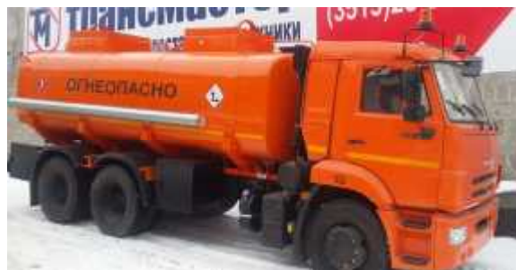
Рисунок 2 - Общий вид АТЗ с двумя секциями
