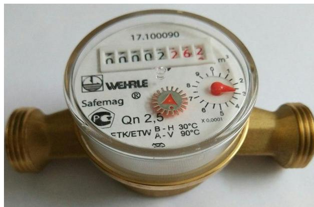
Рисунок 2 - Счетчик воды универсальный ETK/ETW «Wehrle»
