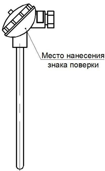
Рисунок 6 - Место нанесения знака поверки
