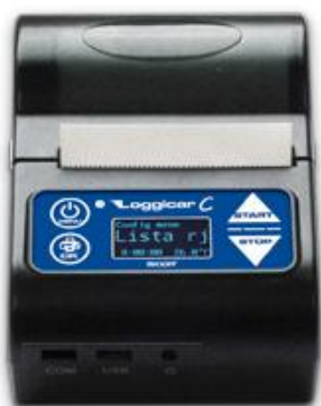
Рисунок 1 - Общий вид электронных блоков регистраторов температуры Loggicar-C
