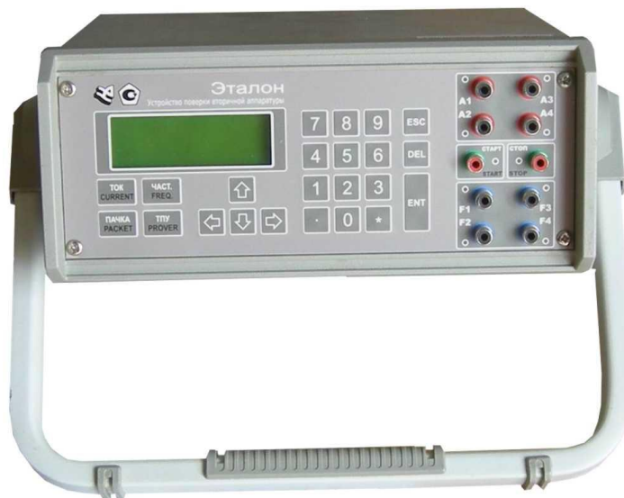
Рисунок 1 - Общий вид устройств поверки вторичной аппаратуры «УПВА-Эталон»
