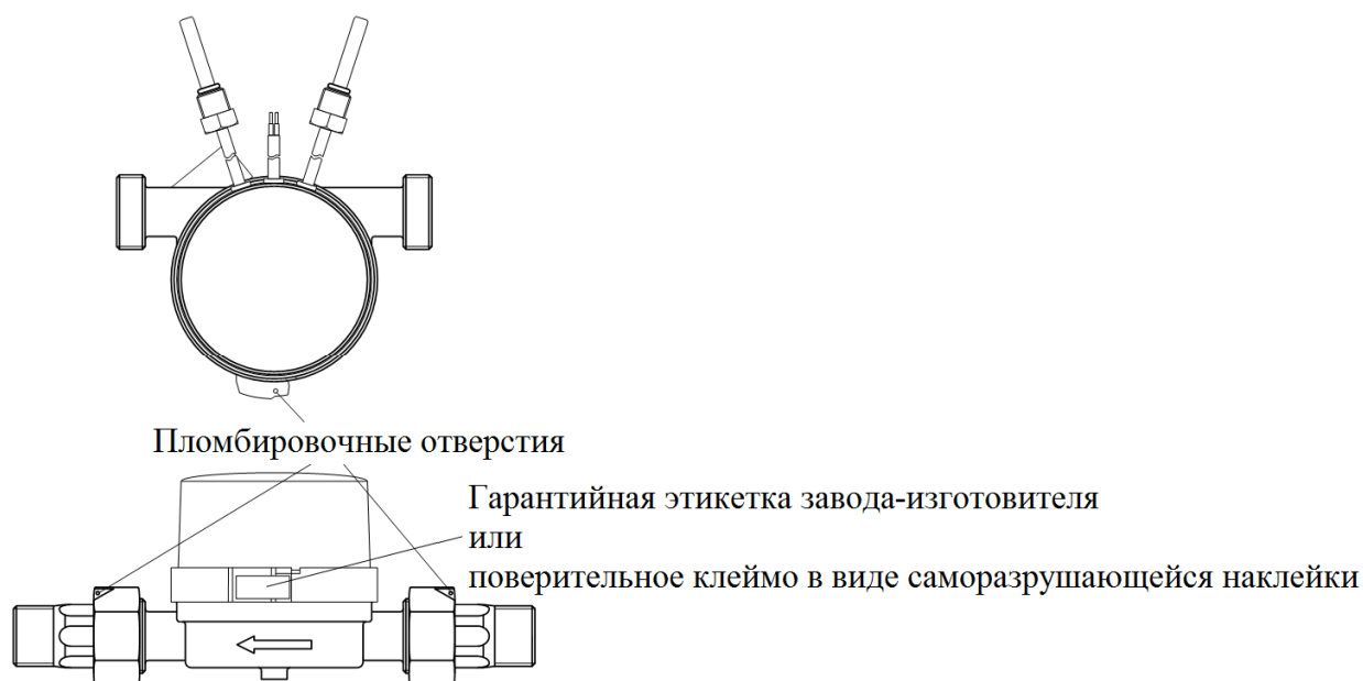
Рисунок 4 - Схема пломбировки от несанкционированного доступа, обозначения места нанесения знака поверки на счетчики тепла Гефест 15.A2.I, Гефест 15.A2.R, Гефест 15.A2.M, Гефест 15.A2.F
