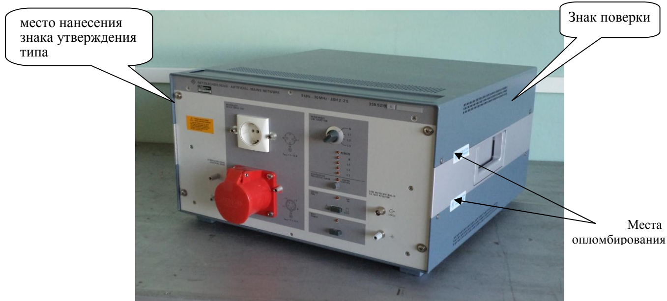
Рисунок 1 - Внешний вид эквивалента сети с указанием мест опломбирования, знака утверждения типа и знака поверки
