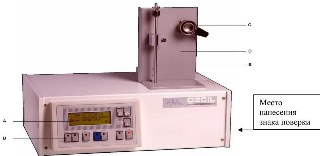
Рисунок 1 - Общий вид рефрактометрического детектора CE 4700
