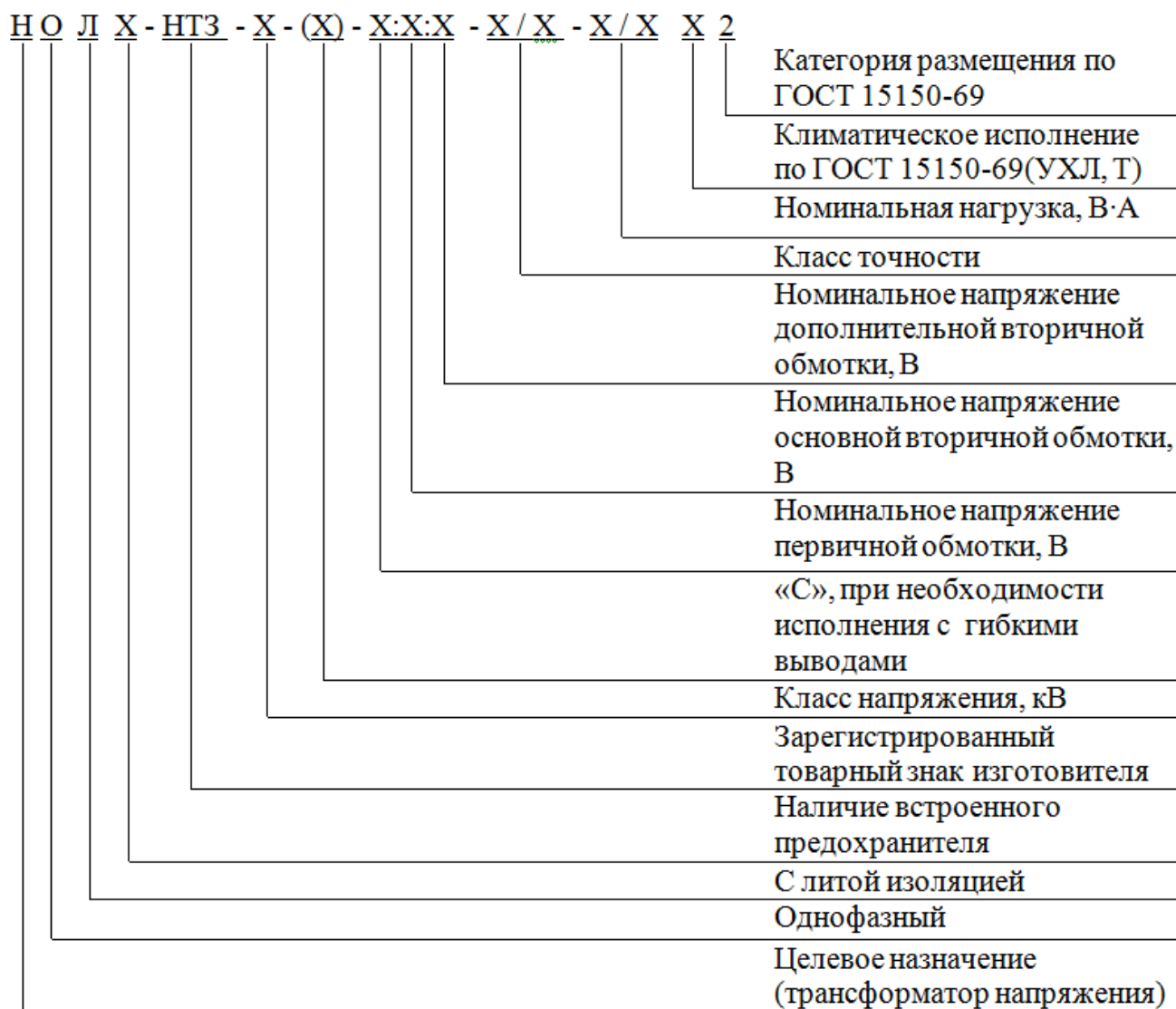
Рисунок 3 - Структура условного обозначения трансформаторов напряжения НОЛ(П)-НТЗ
