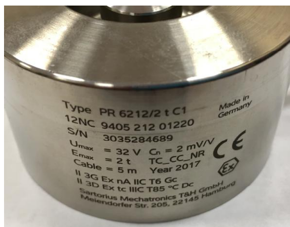
Рисунок 2 - Маркировочная табличка датчиков весоизмерительных PR 6201, PR 6212
