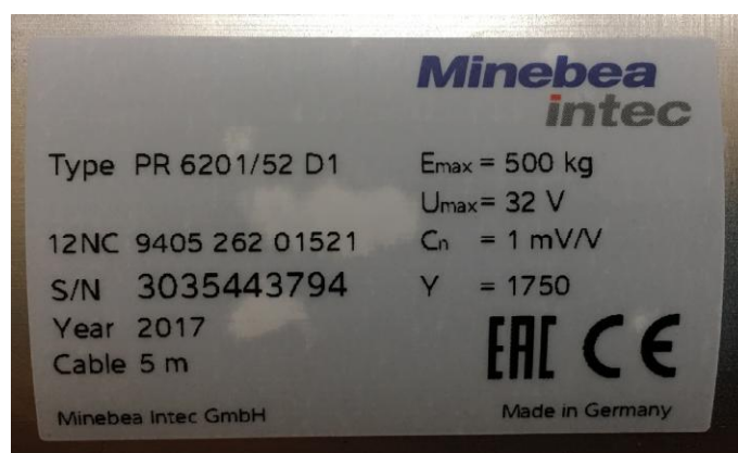
Рисунок 2 - Маркировочная табличка датчиков весоизмерительных PR 6201, PR 6212
