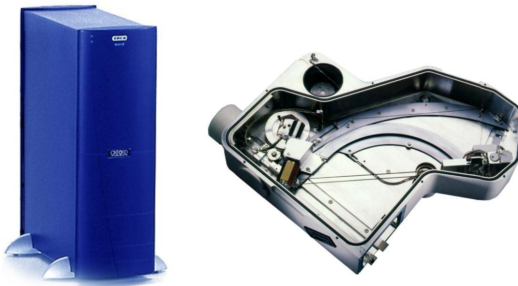
Рисунок 1 - Общий вид спектрометра рентгеновского с волновой дисперсией Inca Wave 700
