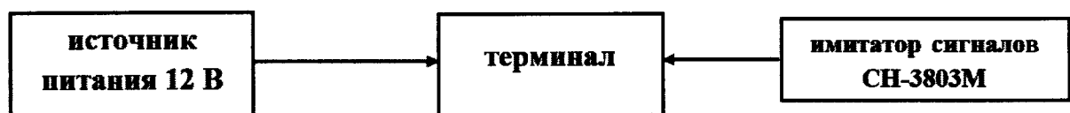
Рисунок 1 – Схема проведения измерений при проверке работоспособности
