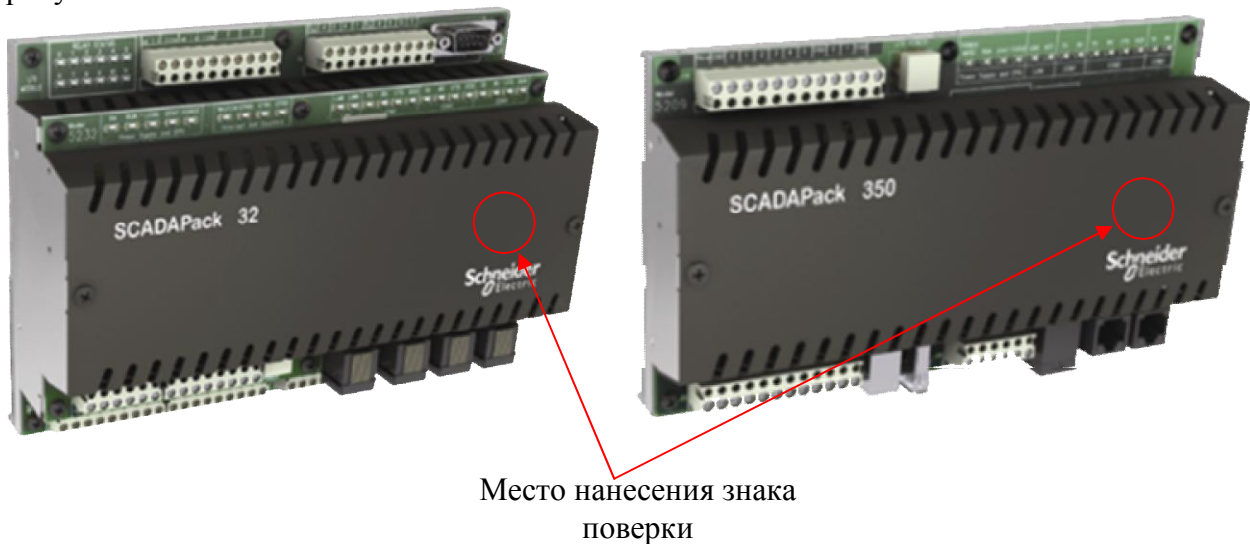
Рисунок 1 – Пример внешнего вида контроллеров с указанием мест пломбирования и нанесения знака поверки
